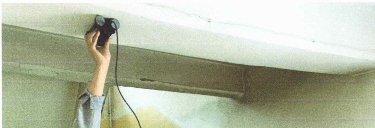
Зураг 21. Төмөр бетон дамнуруу шалгаж буй байдал.
